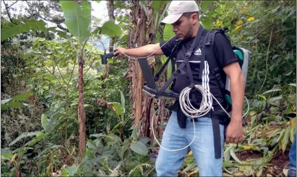
Figura 19. Proceso de captura de firma espectral para la elaboración de modelos de corrección atmosférica de imágenes de sensores remotos
