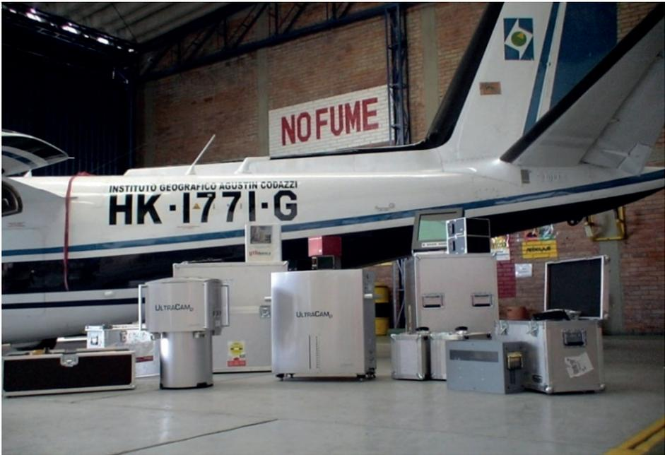
Figura 13. Avión del IGAC-Plataforma para Ultracam Vexcel
