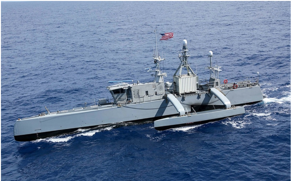
Figura 2. Buque de superficie no tripulado de desplazamiento medio Sea Hunter
