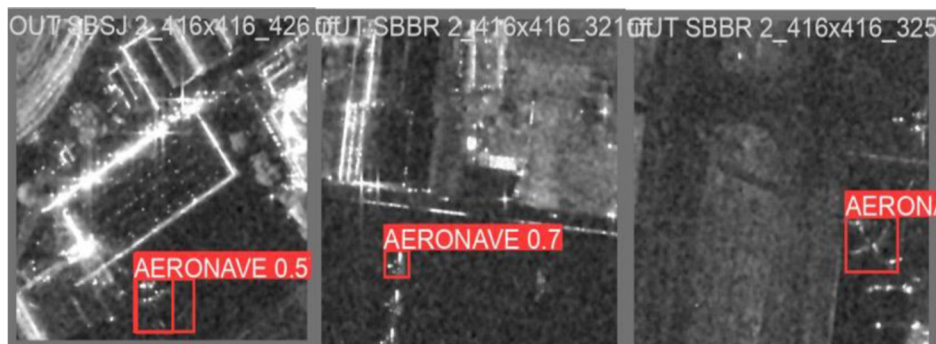
Figura 5. Detección de aeronaves en aeropuertos internacionales mediante imágenes SAR Lessonia, en banda X y con polarización VV
