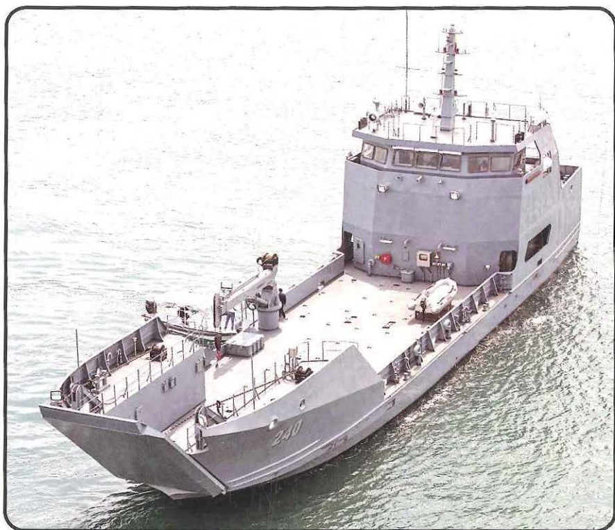
Unidad tipo BDA (Buque de Desembarco Anfibio) diseñado y construido por COTECMAR. Cinco unidades de este tipo han sido construidas para la Armada Nacional de Colombia y una para la Armada de Honduras (2017).
