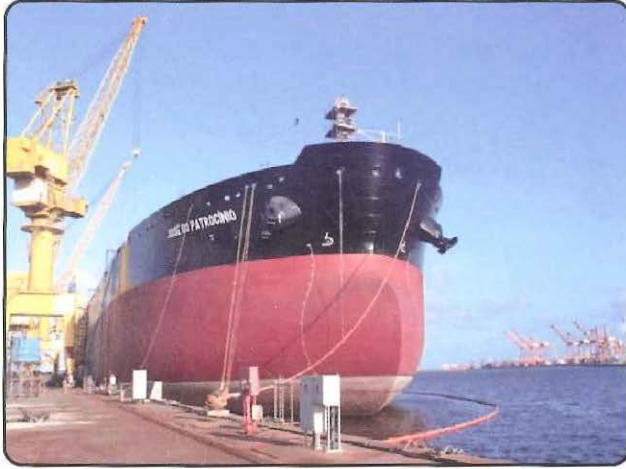
Buque petrolero "José do Patrocínio" de 274 metros de eslora con capacidad de transportar 157.000 toneladas de petróleo construido en astilleros de Pernambuco (Brasil).
