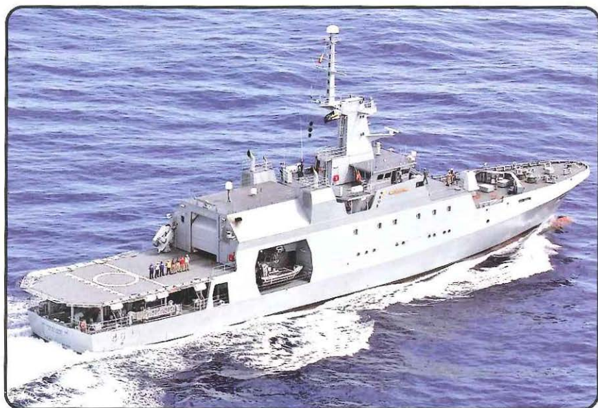
Patrullera de Zona Económica Exclusiva tipo OPV 93C. Segunda generación de unidades OPV. Diseñada y en proyecto de construcción por COTECMAR (Colombia). Foto tomada de www.COTECMAR.com/productos/opv93
