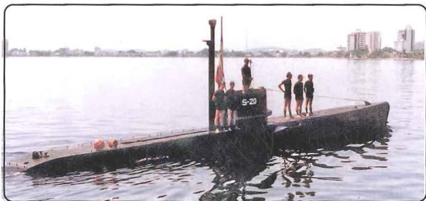
Submarino Táctico tipo SX 506 ARC Intrépido (S-20) de la Armada Colombiana fabricado por astilleros Cos.Mo.S. de Livorno (Italia).
