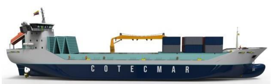
Figura 7.10. Buque de Cabotaje para transporte de carga de contenedores y granel
